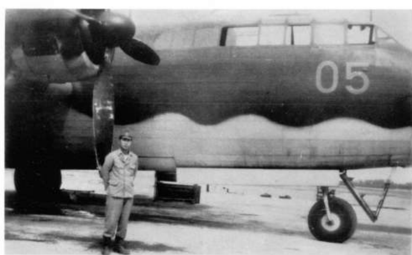
▼ 第1021海軍航空隊の「深山改」輸送機第3号機(21-03)の前に立つ操縦の菅田 福中尉。写真左下方、前車輪の前に胴体前部出入口用の折りたたみ式ステップが見える。主翼は並翼だったDC-4のものを中翼にしたため一部構造を改めている。
