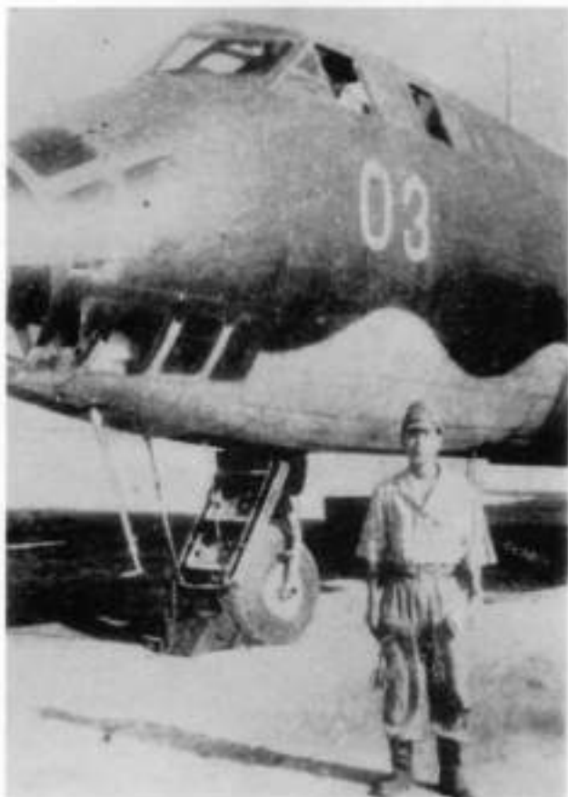
▼ 左の写真と同じ1021空の「深山改」輸送機第3号機の機首部分で、立っているのは上の写真と同じ「深山改」輸送機の整備を担当した藤沼整備兵曹長。機首出入口と折りたたみ式ステップ、それに胴体左下方斜めに出ているピトー管がよくわかる。
