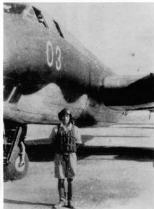
▼ 第1021海軍航空隊の「深山改」輸送機第3号機(21-03)の前に立つ操縦の菅田 福中尉。写真左下方、前車輪の前に胴体前部出入口用の折りたたみ式ステップが見える。主翼は並翼だったDC-4のものを中翼にしたため一部構造を改めている。
