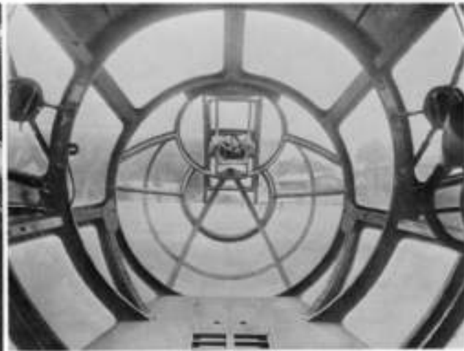
▲ 内側から見た「深山」1号機の7.7mm機首銃座。機首の風防は回転式となっている。さらに左右には、各1個の7.7mm予備銃架（写真左右の内形のもの）が設けられている。下方の窓は爆撃照準器用で、使用する際は床枠を開く。
