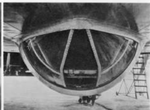
▲ 内側から見た「深山」1号機の7.7mm機首銃座。機首の風防は回転式となっている。さらに左右には、各1個の7.7mm予備銃架（写真左右の内形のもの）が設けられている。下方の窓は爆撃照準器用で、使用する際は床枠を開く。
